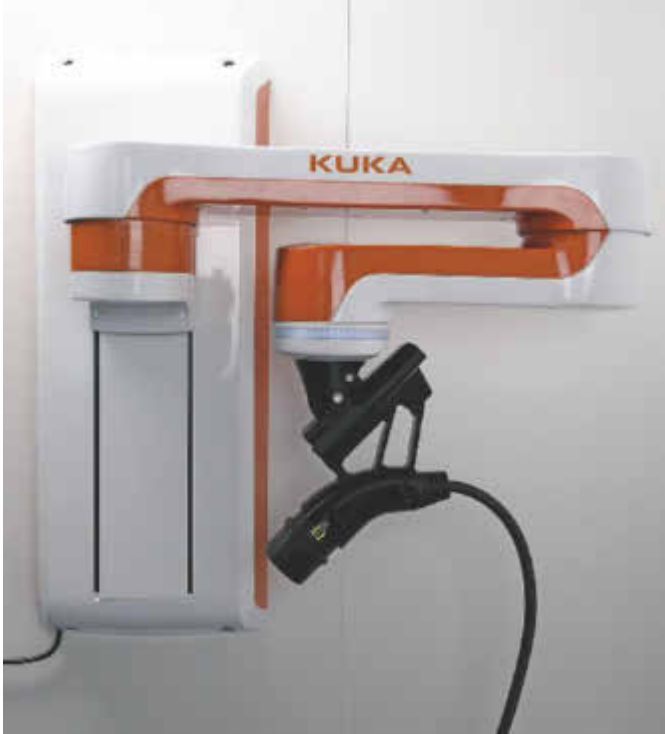
Um den Ladestecker am Fahrzeug zu erkennen, ist der Ladeassistent mit einer Kamera und einem ausgeklügelten Bildverarbeitungssystem ausgestattet. Bild: Forward tcc
